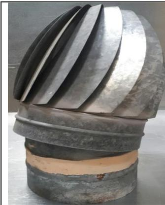
El eje se ha doblado debido a la acción del viento. El fallo es debido al escaso diámetro del eje, y a que dicho sistema no tiene estructura estabilizadora
